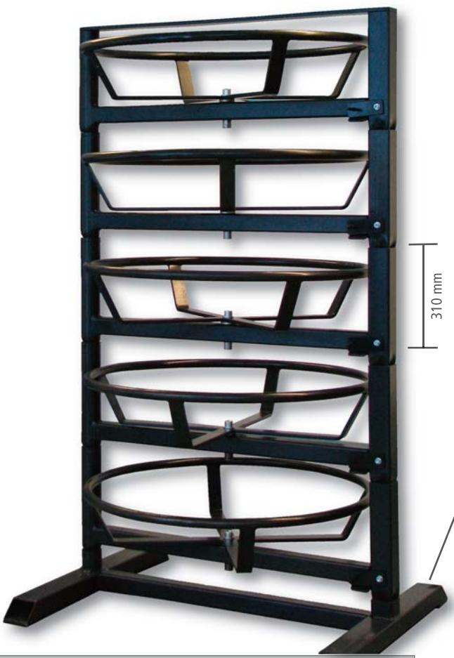
Der UNIFLEX Schlauchhaspel USH 4 für die einfache Aufbewahrung Ihrer Hydraulikschläuche. Der einfache Aufbau bietet Ihnen die Möglichkeit bis zu sieben Etagen, mit je einem Aufbewahrungskorb, übereinander zu stapeln. Jeder Korb ist einzeln schwenkbar, der Fuß wird zur Sicherheit im Boden verschraubt.
